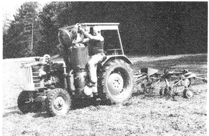
Abb. 1: Landwirtschaftstraktor Hürlimann Typ D 110, umgebaut auf Diesel-Holzgasbetrieb. 4,5 kg Holz ersetzen im Durchschnitt einen Liter Dieseltreibstoff.
