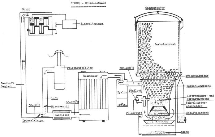
Abb. 2: Funktionsschema der Dieselholzgasanlage.
