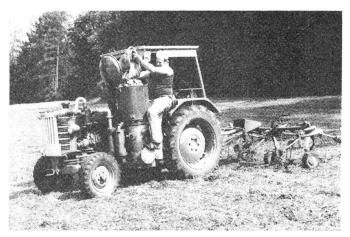
Abb. 1: Landwirtschaftstraktor Hürlimann Typ D 110, umgebaut auf Diesel-Holzgasbetrieb. 4,5 kg Holz ersetzen im Durchschnitt einen Liter Dieseltreibstoff.
