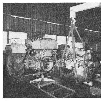
Abb. 2: Kostengünstiger Einbau eines Ersatzmotors in einer Bührer-Vertragswerkstätte.
