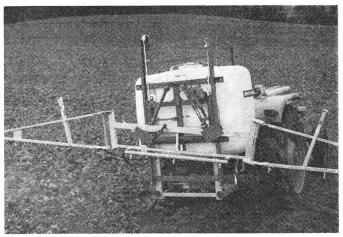
Traktor auf den Spritzbalken. Der Spritzbalken bleibt dadurch ruhig und in paralleler Lage zum Boden. — Wird der Pendelrahmen zusätzlich mit einem elektromechanischen Hubzylinder ausgerüstet, kann der Spritzbalken auch in Hanglagen parallel zum Boden eingestellt werden.
