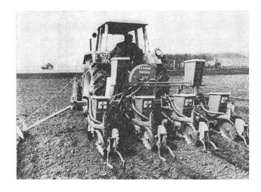
Wie bei keiner anderen Fruchtart ist gerade bei Rübe und Mais die Qualität der Aussaat, neben sachgemässer Feldherrichtung und termingerechter Saat, entscheidend für den Ertrag. Nur sorgfältige Einzelkornablage gewährleistet einen hohen Feldaufgang und somit geschlossenen Bestand. Die Omega der Reformwerke Bauer & Co., GmbH, Wels, erfüllt die hohen Anforderungen hinsichtlich fortschrittlicher Sätechnik.
