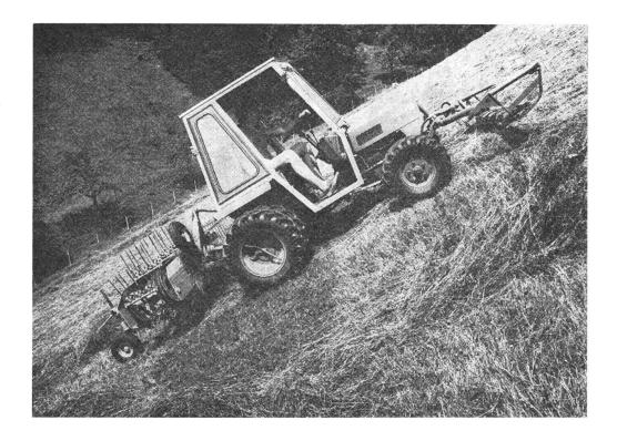
stungsschwachen Traktoren abzurücken, bedient er sich eines kleinen Standard-Traktors mit zusätzlichem Vorderradantrieb und einer Motorleistung von rund 20 kW (27 PS). Auf die tiefe Schwerpunktlage wurde dabei besonders geachtet. Die Vorteile dieser Maschine sind folgende:
