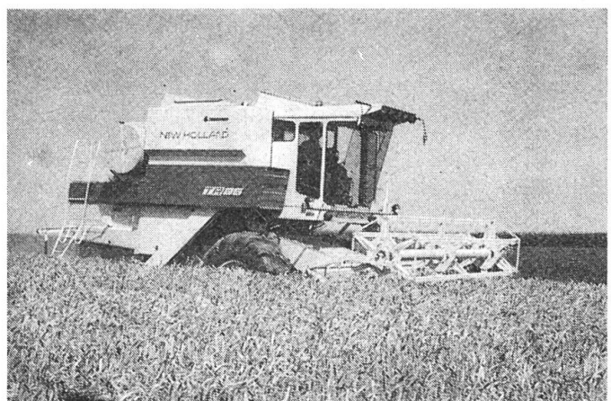
Abb. 5: Mähdrescher mit Vollhangausgleich. Wenn die Hangneigung den Ausgleichsbereich nicht überschreitet, sind die Arbeitsbedingungen praktisch gleich wie in der Ebene.
