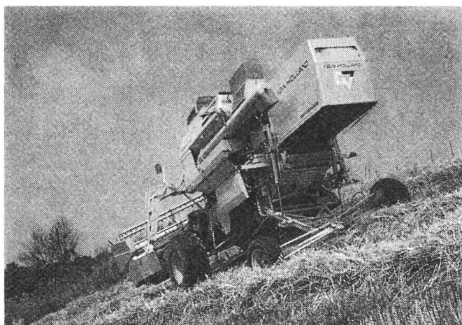
Abb. 4: Bei der Arbeit hangauf- und -abwärts zeigen Axialmähdrescher gewisse Vorteile.
