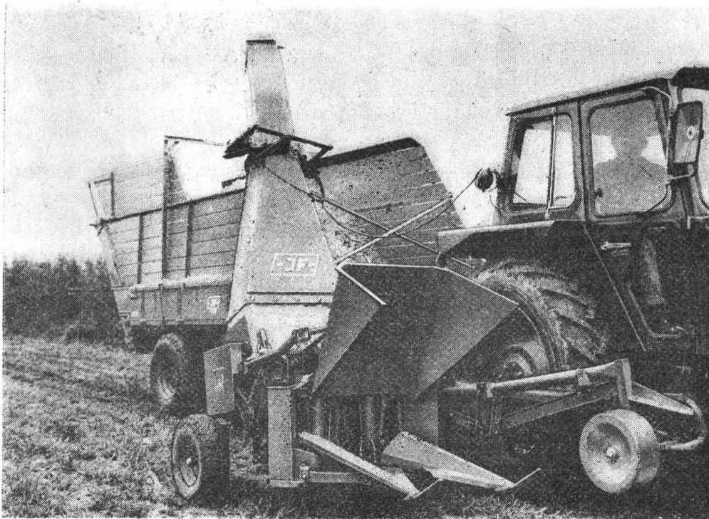
Das Futter wird nach oben geschnitten. Die Gegenschneide ist oben angebracht, und das Erntegut wird nach dem Häckseln in den «Kamin» geworfen.
