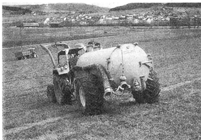
Abb. 10: Druckfass mit einer optimalen Bereifung für eine gute Bremswirkung. Das Profil der AS-Reifen ist für eine gute Selbstreinigung beim Bremsen in umgekehrter Laufrichtung montiert.
