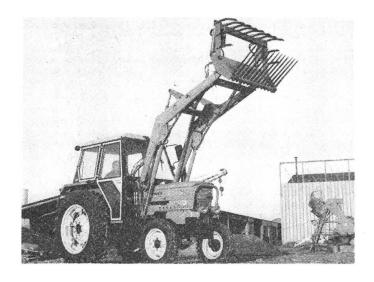
Das ganze Geheimnis dieses Laders besteht in seiner sehr grossen Losreisskraft an der Schaufel. Die Abtragzylinder üben am Schaufelende eine maximale Kraft aus (bis zu 1500 kg) und sichern eine grössere Ausschüttgeschwindigkeit. Dank dieser Kraft können die schwierigsten Lasten auf einmal vom Boden gelöst werden, wodurch mehrere Hin- und Herbewegungen zur Füllung einer Schaufel überflüssig werden. Bei Kartoffeln wird deren Beschädigung vermieden.
