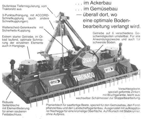
TORONADO 1300, 1,3 m Arbeitsbreite, 300 kg, ab 30 PS, 1-2 Geschwindigkeiten TORONADO 2300, 2,3 m Arbeitsbreite, 550 kg, TORONADO 2500, 2,5 m Arbeitsbreite, 630 kg, TORONADO 3000, 3,0 m Arbeitsbreite, 810 kg, 75-150 PS, 2-6 Geschwindigkeiten TORONADO 3000, 3,0 m Arbeitsbreite, 810 kg, 75-150 PS, 2-6 Geschwindigkeiten
