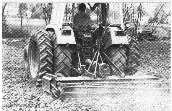
Abb. 2: Im schweren Boden wurde mit der Feingrubberkombination mit Doppelkrümmer nach drei Durchgängen ein mittel- bis grobscholliges Saatbett hergestellt. Mit der Bodenfräse (mitte) und besonders der Kreiselegge (unten) konnten die Schollen bedeutend besser zerkleinert werden.
