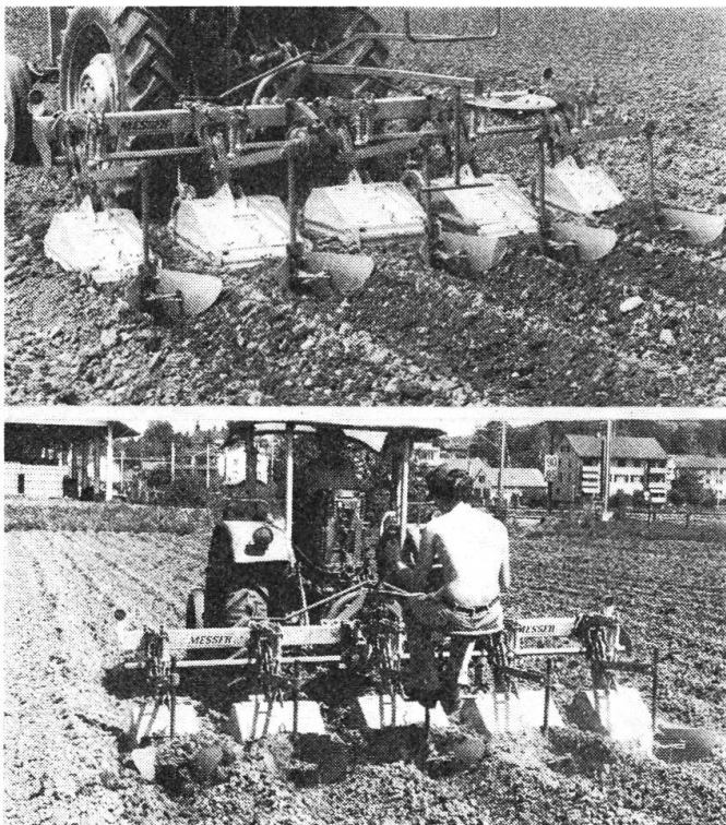
Abb. 8: Im schweren Boden wurden die in 5 bis 6 cm Tiefe liegenden Schollen besonders nach dem zweiten Durchgang (unten) merklich zerkleinert und hohe breite Dämme aufgebaut.
