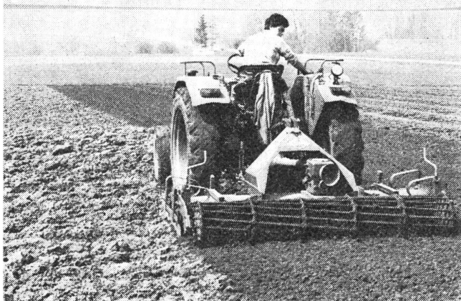
Abb. 1: Die Saatbettvorbereitung im mittelschweren Boden konnte mit allen drei Geräten ohne besondere Schwierigkeiten vorgenommen werden. Mit der Kreiselegge (unten) und besonders der Bodenfräse (mitte) wurde praktisch eine schollenlose Bodenstruktur erreicht.
