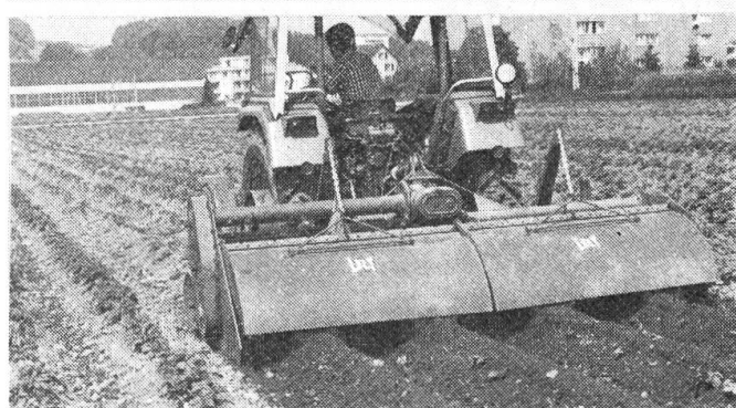
Abb. 6: Für den Aufbau flacher Dämme beim ersten Durchgang (oben) müssen die Leitbleche hochgestellt werden. Bei tiefer Stellung der Leitbleche lassen sich relativ hohe Dämme herstellen.
