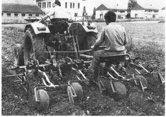
Abb. 3: Mit dem Vielfachgerät kann das Striegeln, Hacken und Häufeln in einem Arbeitsgang durchgeführt werden. Die Arbeitsqualität war im mittelschweren Boden gut. Für das Hochhäufeln beim zweiten Durchgang (unten) sollen die Häufelscheiben möglichst breit gestellt und die Fahrgeschwindigkeit auf 5 bis 6 km/h reduziert werden.
