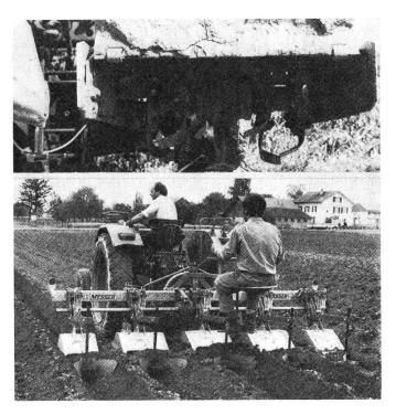
Abb. 7: Mit der Reihen-Messerfräse mit gefederter Führung der Arbeitswerkzeuge lässt sich eine gute Arbeitsqualität erreichen (mittelschwerer Boden).
