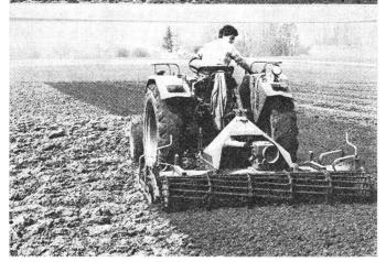
Abb. 1: Die Saatbettvorbereitung im mittelschweren Boden konnte mit allen drei Geräten ohne besondere Schwierigkeiten vorgenommen werden. Mit der Kreiselegge (unten) und besonders der Bodenfräse (mitte) wurde praktisch eine schollenlose Bodenstruktur erreicht.
