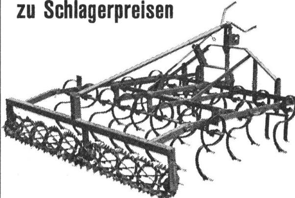
für 3-Punkt-Anbau, mit 4 Zinkenreihen und über Spindeln höhenverstellbarem Spitzzahn-Ein- oder -Zweiwalzenkrümmer.
