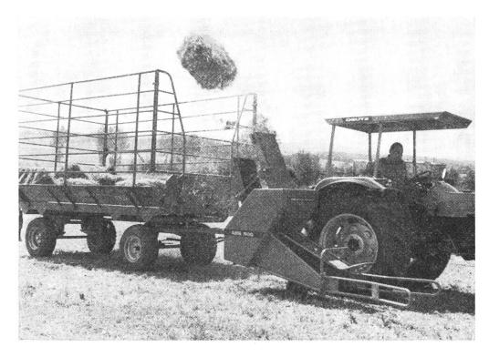
die Ballenpresse, um das Pressen und Laden im gleichen Arbeitsgang auszuführen, derweilen das andere Modell die am Boden liegenden Hartballen im separaten Arbeitsgang aufnimmt und auf den Anhänger wirft. Beide ermöglichen einstellbare Wurfweiten von 3–9 Meter und beide zeichnen sich durch grosse Betriebssicherheit und ausgesprochen einfache Handhabung aus.
