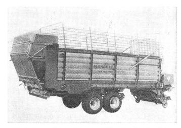
Abb. 2: Mengele Ladewagen LW 310 Quadro (DLG-Neuheit 1980) mit neuem Hochleistungs-Schwingförderer.
