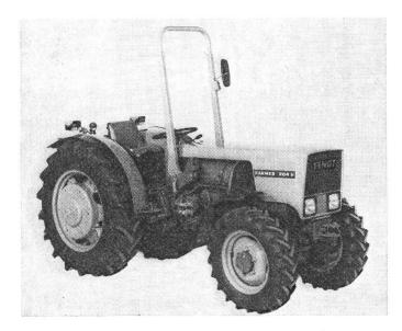
FENDT Spezialtraktor Farmer 204 V, 48 kW / 65 PS Sein gedrosselter Vierzylindermotor leistet 65 PS. Das «Energiebündel» hat Kraft für schwerste Zapfwellenarbeiten im Weinberg und bewährt sich durch seinen Allradantrieb hervorragend in sehr steilem Gelände.
