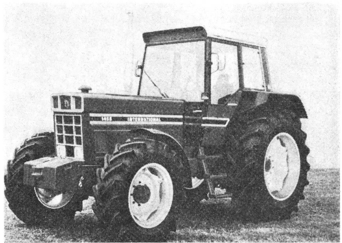
Abb. 1: International-Allrad-Traktor 1455 mit IH-6-Zylinder-Motor 107 kW (145 PS). Optimal abgestuftes Vollsynchron-Getriebe / Planeten-Allrad-Achsen mit automatischen Selbstsperr-Differential / Starke IH-Regel-Hydraulik.
