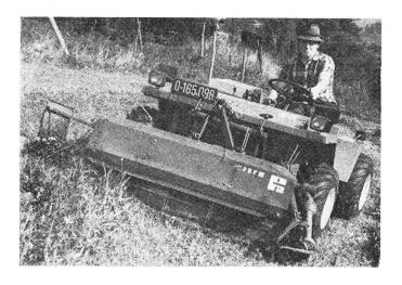
an unebenes Gelände pendelnd aufgehängt. Der Metrac 2002 wurde serienmässig mit einem hydraulischen Fronthubwerk ausgestattet, das ein müheloses und rasches Ausheben aller Frontgeräte ermöglicht. Ein Schnellkoppelsystem an der Fronthydraulik erlaubt einen raschen Gerätewechsel im Einmannverfahren. Zum Mähen wird der Metrac 2002 mit einem vorne angebauten Busatis-Doppelmessermähwerk mit 2 m Arbeitsbreite ausgerüstet.
