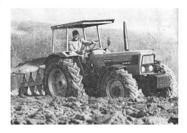
zylindermotor S4L 913 mit einem Hubraum von 4085 cm³, verfügt über grosse Kraftreserven und einen bemerkenswerten Drehmomentanstieg. Das neue Getriebe TW 56.20 bietet optimal abgestuft 12 Vor- und 4 Rückwärtsgänge. Besonderer Wert auf einen gesundheitlichen Arbeitsplatz gelegt, bei dem alle Bedienungsorgane praktisch und bequem erreichbar sind.
