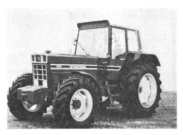
Abb. 1: International-Allrad-Traktor 1455 mit IH-6-Zy-linder-Motor 107 kW (145 PS). Optimal abgestuftes Vollsynchron-Getriebe / Planeten-Allrad-Achsen mit automatischen Selbstsperr-Differential / Starke IH-Regel-Hydraulik.
