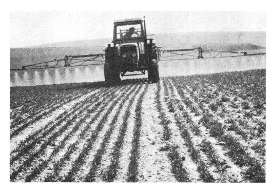
Abb. 5: Flüssigdüngung mit einer Feldspritze.
