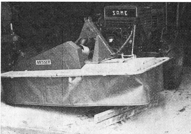
Abb. 4: Landwirtschaftlich genutztes Land ist nie absolut eben; daher ist eine gewisse Verwindbarkeit des Mähwerkes zum Traktor unerlässlich.
