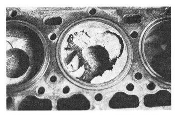
Abb. 37: Kolbenschaden, verursacht durch defekte Einspritzdüse.
