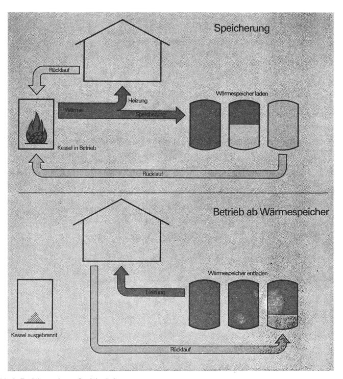
Abb. 8: Funktionsschema Speicherheizung.
