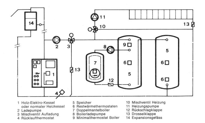
Abb. 6: Prinzipschema einer Holz- oder Holzelektrospeicherheizung.
