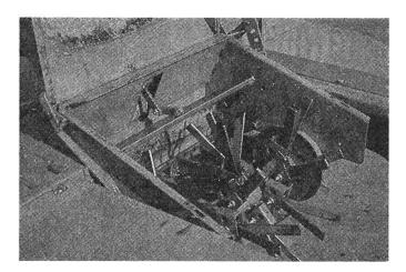
Abb. 2: Zinkenrotoren als Aufbereiter sind heute stark verbreitet.
