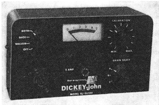
Dieses neue Gerät stammt von Dickeyjohn, einer auf Landwirtschafts-Elektronik spezialisierten Firma in den USA und erlaubt, die Leistungsfähigkeit der Mähdrescher optimal auszunützen. Das Anzeigegerät, welches im Führerstand montiert wird, erhält seine Informationen von fünf Sensoren. Zwei Sensoren erfassen die Körner beim Austritt hinter den Sieben, zwei
