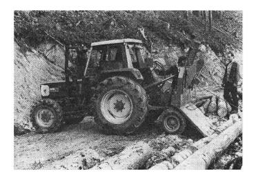
Die Schaltfunktionen werden beim neuen Rückewagen hydraulisch ausgeführt. Das gilt nicht nur für die Einstellung des Oberlenkers, sondern auch für die Steuerung der Seilwinde. Für Letzteres ist ein eigenes Steuergerät vorhanden, das nach Wunsch am Traktor oder am Rückewagen aufgesteckt werden kann. Die Funktionen «Zuzug – Bremsen – Seilauszug» werden bei diesem Gerät mit nur einem Hebel geschaltet.
