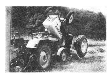
Abb. 3: Gerade noch Glück gehabt! Beim Abschleppen eines steckengebliebenen Ladewagens landete der Abschlepptraktor auf der Motorhaube des Zugtraktors. Der Hohlraum zwischen beiden Traktoren hat den Traktorfahrer vor dem sicheren Erdrückungstod bewahrt.
