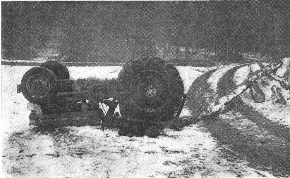
Abb. 2a: Der geschleppte Baumstamm geriet wegen Aufliegens auf andern Stämmen in Fahrt und überriss beim Ausfahren vom Feldweg zum Holzstapelplatz den Traktor.
