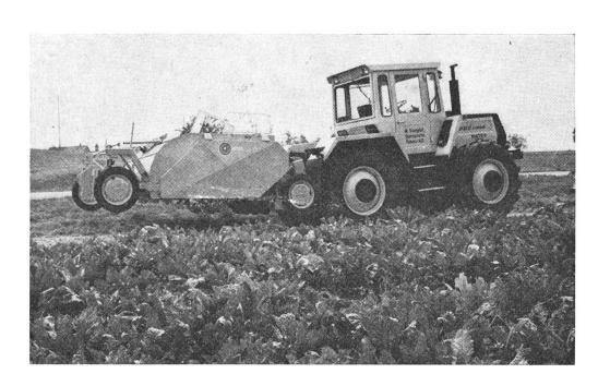
Abb. 5: Diese Maschine schippt und rodet 6-reihig. Die Leistung ist enorm, wenn das Laub auf dem Acker bleibt.
