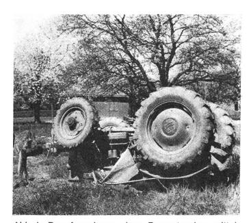
Abb. 1: Das Ausreissen eines Baumstrunkes mittels einer zu hoch angehängten Zugkette hatte das Rückwärts-Ueberschlagen des Traktors und den Erdrükkungstod des Traktorlenkers zur Folge.
