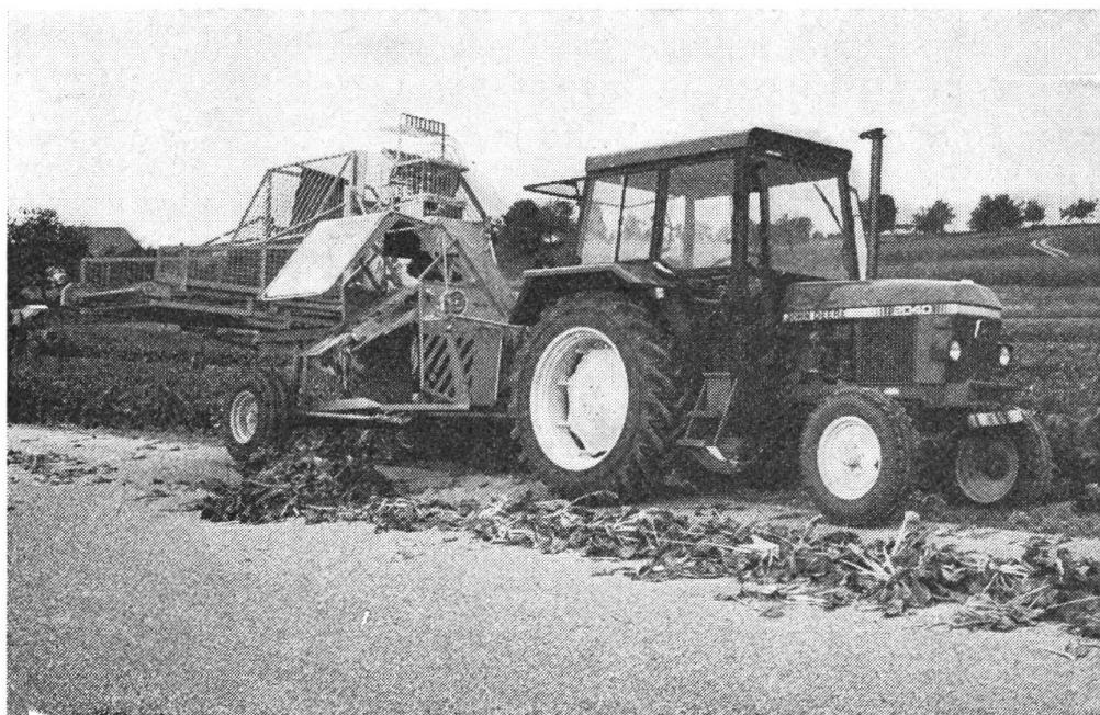
Abb. 2: Mit dieser Maschine werden einreihig gleichzeitig Laub und Rüben geerntet. Das Laub wird in Schwaden abgelegt und die Rüben gelangen in den Vorratsbunker. Sie können am Feldrand auf bereitstehende Wagen geladen oder an Haufen geschüttet werden.
