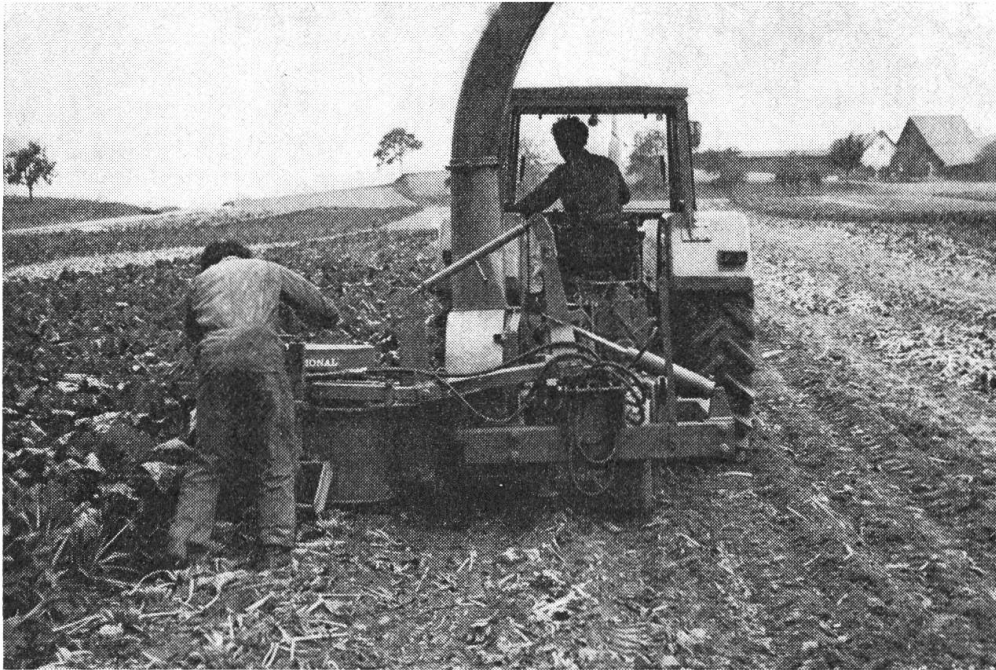
Abb. 3: Bei der zweiphasigen Ernte wird zuerst das Laub vorgeschippt, prak- tisch ohne Köpfe.
