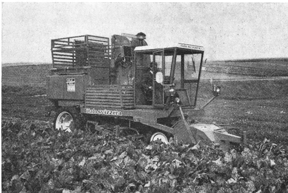
Abb. 7: Wie bei allen selbstfahrenden Maschinen können auch beim Rübenvollernter die der Fortbewegung dienenden Teile (Motor, Getriebe, Fahrwerk), welche in der Grösse und im Preis einem leistungsfähigen Traktor entsprechen, nur während relativ kurzer Zeit verwendet werden.
