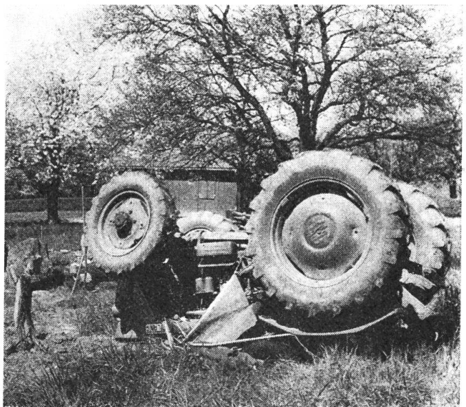
Abb. 1: Das Ausreissen eines Baumstrunkes mittels einer zu hoch angehängten Zugkette hatte das Rückwärts-Ueberschlagen des Traktors und den Erdrückungstod des Traktorlenkers zur Folge.
