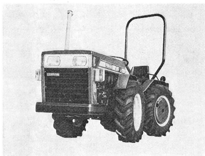
Der neue Ferrari-Allrad-Traktor F 95 mit 3 Zylinder-Viertakt-Dieselmotoren, normalisierte Zapfwelle 1\frac{3}{8} mit 2 getriebeunabhängigen Geschwindigkeiten. (Foto: Silent AG)
