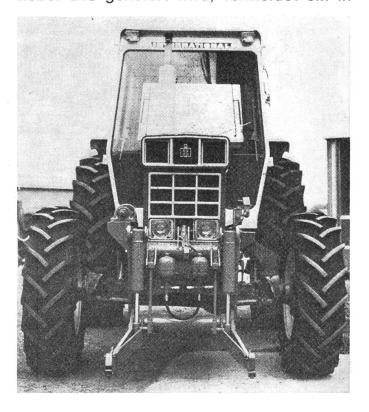
die Gelenkwelle eingebautes Leerlaufrad, dass die Zapfwelle angetrieben wird. Ein dichtes Getriebegehäuse, das auf elastischen Halterungen montiert ist, vermeidet jede Zugbeanspruchung der Zapfwelle des Traktors. Das Gewicht beträgt 160 kg. Durch den Frontkraftheber werden die Lichtkegel der Scheinwerfer nicht verdeckt.
