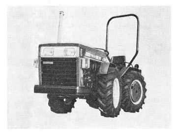
Der neue Ferrari-Allrad-Traktor F 95 mit 3 Zylinder-Viertakt-Dieselmotoren, normalisierte Zapfwelle 1³/8 mit 2 getriebeunabhängigen Geschwindigkeiten. (Foto: Silent AG)
