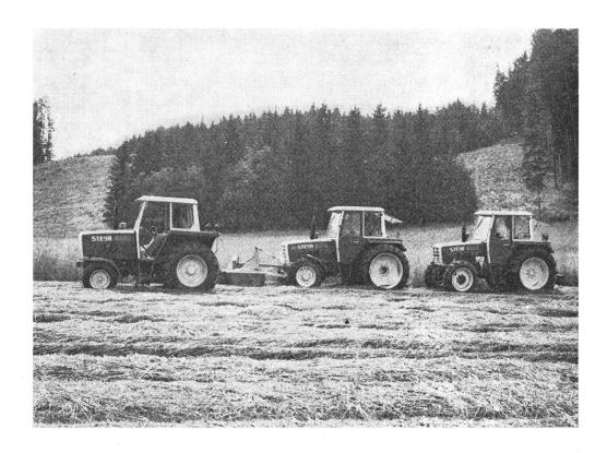
gem Fahrerschutz verfügbar und damit niedriger als vergleichbare Reitsitz-Traktoren. Zu den neuen Typen gibt es speziell entwickelte Anbaugeräte wie Schnellwechsel-Frontlader, Seitenmähwerk, Holzspaltgerät usw.
