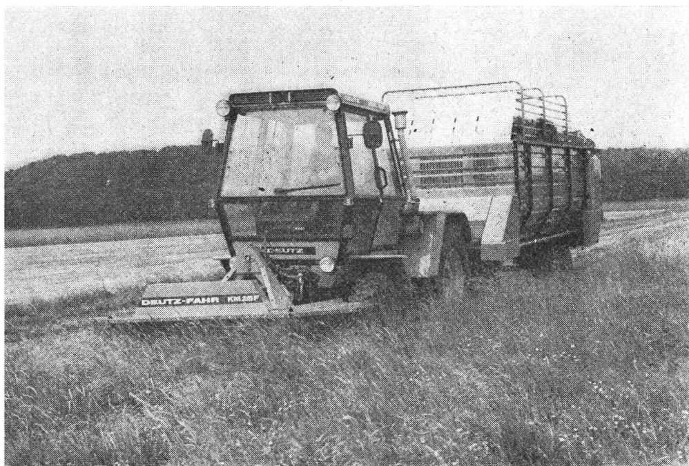
Abb. 3: Düngestreuer mit Einrichtung für die Unterblattdüngung.
