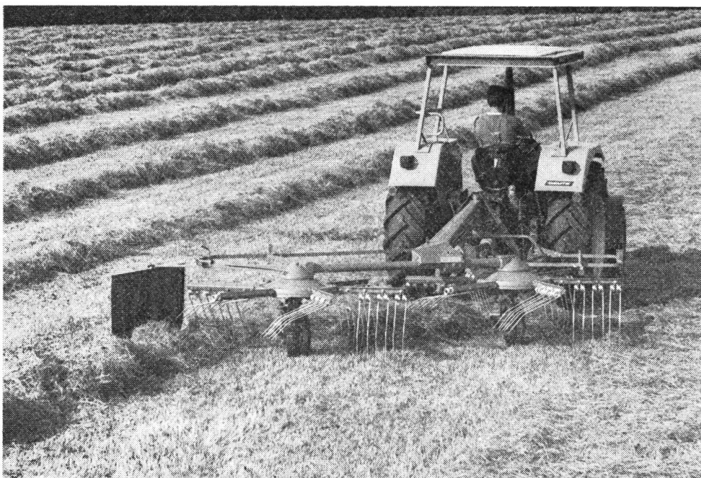
Abb. 5: Zweikreiselschwad- maschine mit einer Arbeitsbreite von 4 m.
