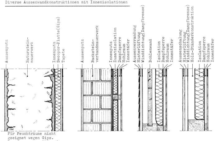
Dampfsperre unnötig, da Isolation dampfbremsend!
