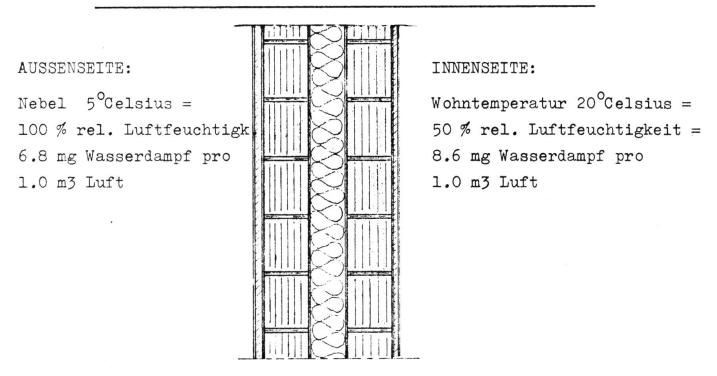
Aussenluft = bei 100 % Luftfeuchtigkeit 1.8 mg Wasserdampf weniger als Innenluft!
