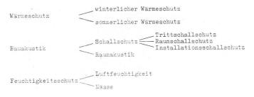
Jedes dieser Isolationsgebiete hat wohl seine eigenen Gesetzmässigkeiten, hängt aber andererseits auch wieder sehr eng mit den anderen zusammen. Eine Wärmedämmung kann einerseits auch ein guter Schallschutz sein, muss anderseits aber auch vor Feuchtigkeit geschützt werden.
