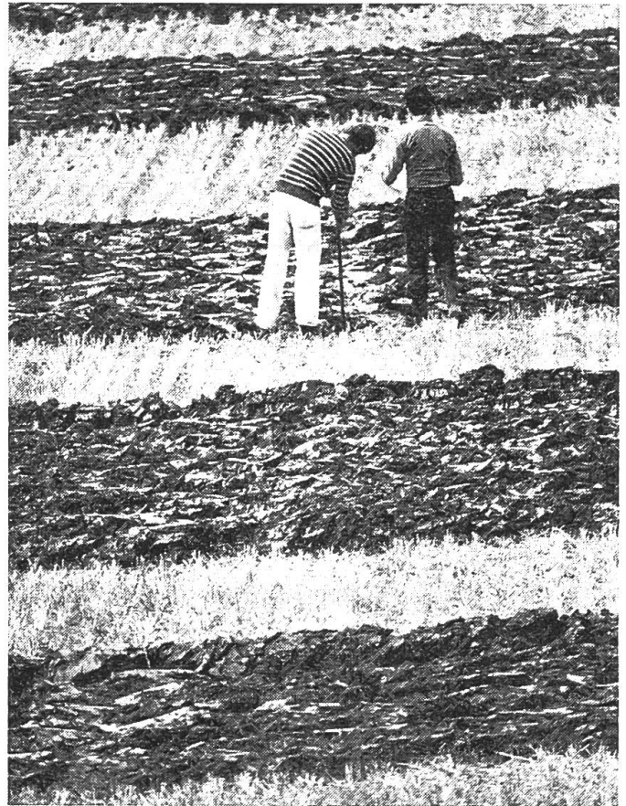
Abb. 3: Zwei neutrale Experten messen die Furchentiefe nach. An anderer Stelle wird geprüft, ob die Furche den geforderten Wendewinkel von 135 Grad aufweist.
