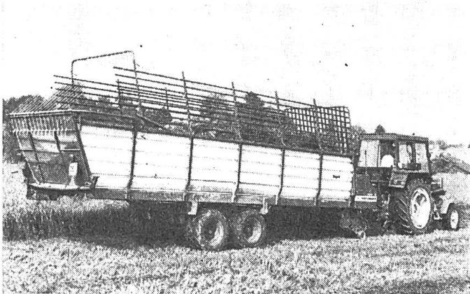
den 6-Kamm-Ladeaggregat, das im Baukastensystem für alle TOP- und Erntewagenmodelle verwendet wird.
