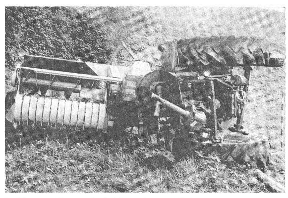
Der Einsatz von Pressen oder Ladekranen im Hanggelände bzw. bei schwierigen Wegverhältnissen ohne Bremsmöglichkeit zum Arbeitsanhänger ist unverantwortlich.
