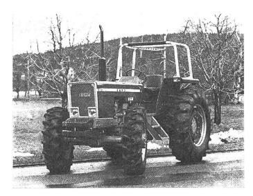
EBRO-Allradtraktor E-6100-DT (mit 6-Zylinder-Diesel PERKINS).
