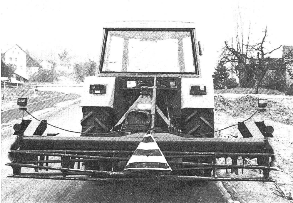
Abb. 4: Für die Markierung der Gerätebreite genügen die Tafeln mit den schwarz/ gelben Streifen und den Rückstrahlern. Da der Krümmer keine scharfen Kanten aufweist, muss er nicht abgedeckt werden. Der Überhang ist mit dem Signalkörper markiert.
