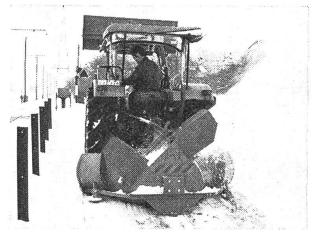
Drei-Punkt zum Ziehen und Stossen mit Wendegetriebe Arbeitsbreite 2,15 m bzw. 2,4 m
