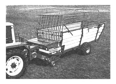
Aehnlich wie beim Kurzschnitt- und Erntewagen seit Jahren, sind ab Produktion September 1980 alle 10 Messer der TREND-Modelle vor Fremdkörpern geschützt. Eine raffinierte Vorrichtung sorgt für ein automatisches Wiedereinschwenken falls Steine, Metallteile und dergleichen passieren. Für rasches Entladen schon bei Leerlauf drehzahl sorgt der neue Doppelhubklinkentrieb. Der Pöttinger TREND ist seit 2 Jahren das meistverkaufte Ladewagenmodell der Schweiz.
