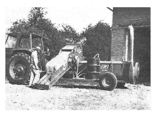
Hauptelemente der Aufschliessanlage sind: Häcksler, Laugenzusetzgerät, Mixer und Fördergebläse.
