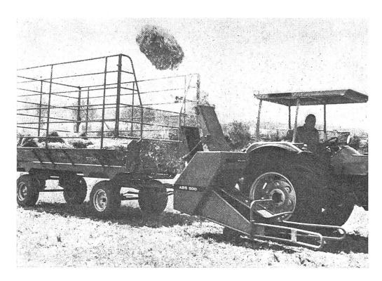
Ballenschleuder Fahr, Modell ABS 500 mit Zapfwellenantrieb.
