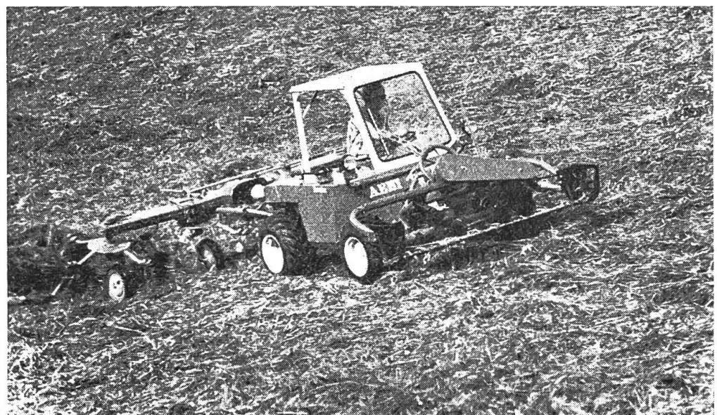
Terratrac AEBI TT 33 mit Turboheuer beim Wenden. Vorne erkennt man das Doppelmesser-Mähwerk «Busatis» (2,00 m).
