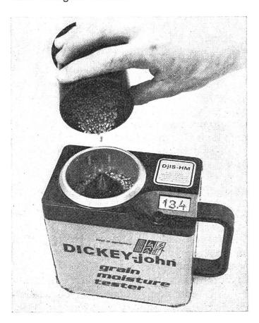
Die Handhabung dieses Gerätes ist äusserst einfach: Eine representative Getreidemenge (ca. 200 Gr.) wird mit einem mitgelieferten Becher, der gleichzeitig als Schutzdeckel dient, langsam in den Messraum geschüttet, bis am Anzeigefenster der Messwert in Zahlen (digital) auf 1/10 genau erscheint.
