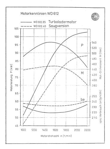
gleich ausgeprägt. In der Regel kann bei Ladermotoren mit einer Verminderung des Treibstoffverbrauches von durchschnittlich 5 Prozent gerechnet werden.
