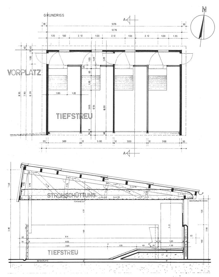
Abb. 2: Grundriss und Schnitt des Offenfrontstalles.
