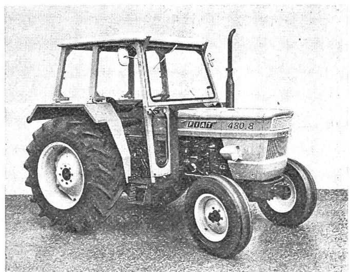
Abb. 2: Ein neuer FIAT-Traktor: Modell 480, mit 2- oder 4-Radantrieb, 12 Vorwärts- und 3 Rückwärtsgängen. Motor 46 DIN-PS. Mit kombinierbarer Sicherheitskabine.
