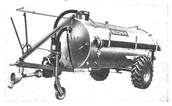
Bucher-Guyer hat die bewährte DF-Reihe um zwei weitere Modelle mit grösserem Fassinhalt erweitert. Das Programm umfasst jetzt 5 Modelle in folgenden Grössen: 2400 I, 3000 I, 4000 I, 5200 I und 6000 I. Alle Modelle sind mit der bewährten Kombinationsdüse mit stufenloser Mengeneinstellung ausgerüstet, die eine speziell exakte und gleichmässige Feldverteilung ermöglicht und sich auch gut zum Bewässern der Kulturen eignet.
