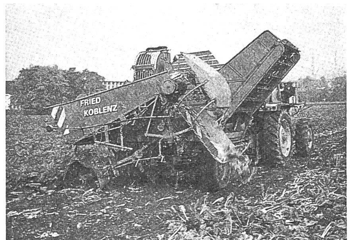
Abb. 1: Der FRIED-SCHMOTZER-Vollernter eignet sich vor allem für schwerere und steinigere Böden. Durch das zweite Sieb wird eine gründliche Rübenreinigung erzielt.
