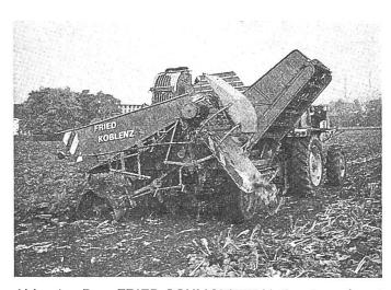
Abb. 1: Der FRIED-SCHMOTZER-Vollernter eignet sich vor allem für schwerere und steinige Böden. Durch das zweite Siebrad wird eine gründliche Rübenreinigung erzielt.
