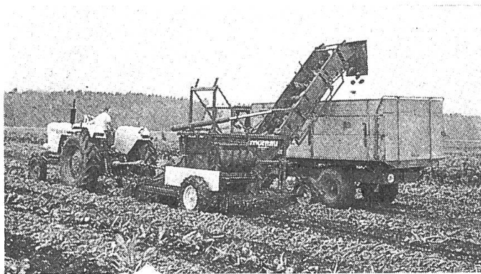
Abb. 8: MOREAU-Landmaschine. Beim Typ CN 10 (nicht abgebildet) werden die von der Siebkette geförderten Rüben mittels einer Abstreiferschnecke auf das Ueberladeband abgelenkt. Der Typ CN 20 (im Bild) ist mit einem Siebrad ausgerüstet. Diese Maschine ermöglicht eine bessere Reinigung; das am Schwad liegende Rübenlaub kann dabei aber etwas stärker verschmutzt werden.
