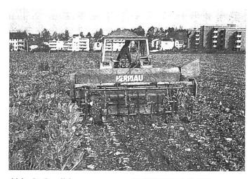
Abb. 6: 6-reihige gezogene HERRIAU-Entblätterungsmaschinen (effeuilleuse). Für die zweiphasige Ernte gibt es auch Frontanbau-Ausführungen. Der Heckanbauraum bleibt damit für den Roder (Abb. 7) frei.
