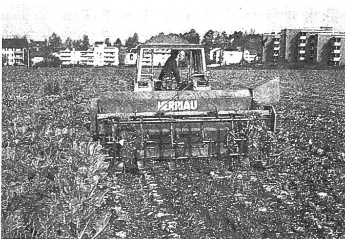
Abb. 6: 6-reihige gezogene HERRIAU-Entblätterungsmaschinen (effeuilleuse). Für die zweiphasige Ernte gibt es auch Frontanbau-Ausführungen. Der Heckanbaubereich bleibt damit für den Roder (Abb. 7) frei.
