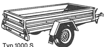
Typ 1000 S mit Kippbrücke 244×122×40 cm Nutzlast 740 kg
