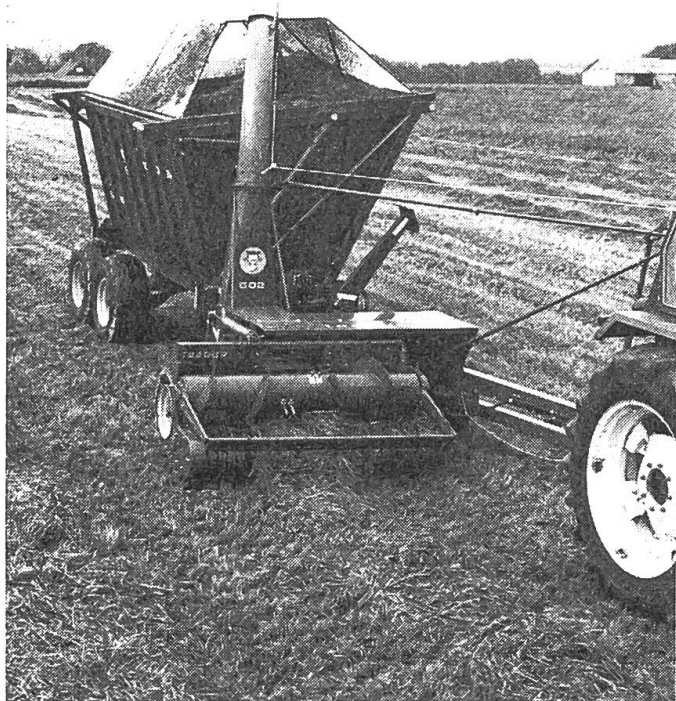
Abb. 1: TAARUP 602 B Exakthäcksler mit Ausrüstungen für direktes Häckseln, Pick-Up oder Maishäckseln (hier montiert mit Pick-Up).
