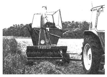
Abb. 2: TAARUP 406 Trommelfeldhäcksler mit Pick-Up oder Maisausrüstung.
