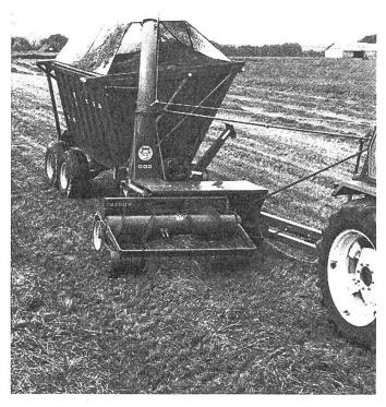
Abb. 1: TAARUP 602 B Exakthäcksler mit Ausrüstungen für direktes Häckseln, Pick-Up oder Maishäcksein (hier montiert mit Pick-Up).
