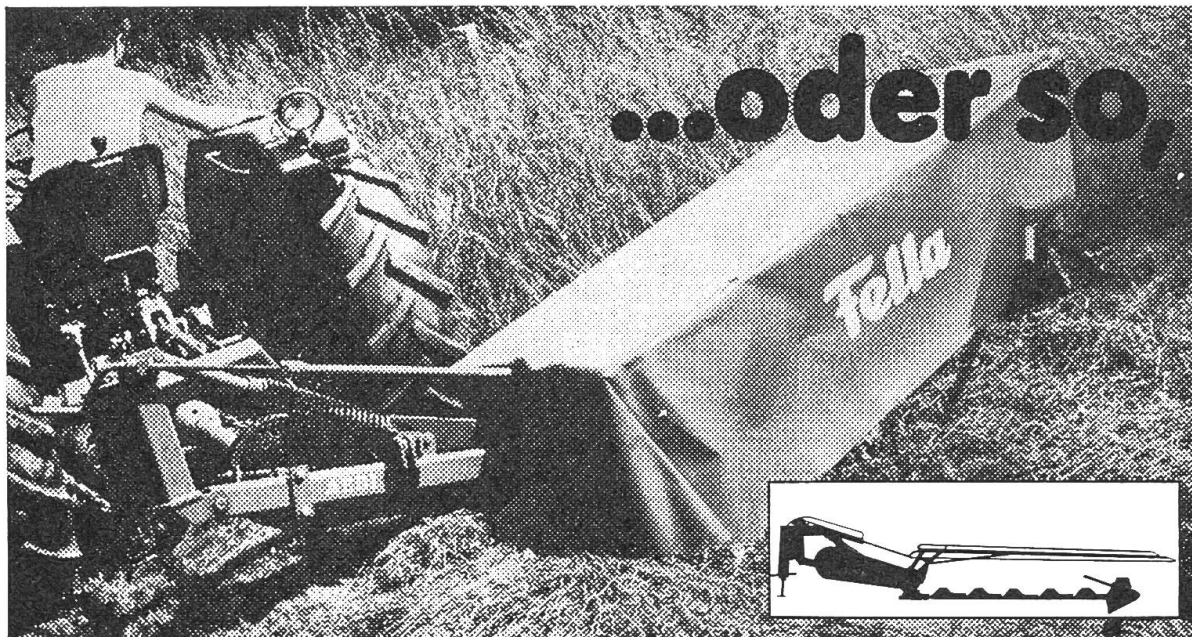
...oder so, Fella Scheibenmäher SM165 und SM240 Arbeitsbreiten 1,65 und 2,40 m. Mit 4 oder 6 Scheiben zu je 3 Messern. Antrieb über Keilriemen und untenliegende Stirnräder im Ölbad. Auflaufsicherung. SM240 mit hydraulischer Aushebung. Grosse Bodenanpassung und geringes Gewicht: ideal in coupiertem Gelände.
