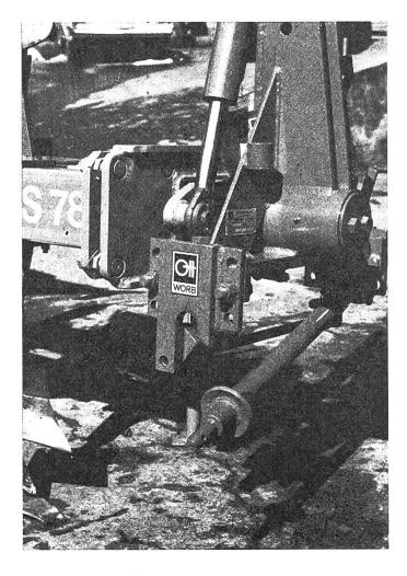
Bei allen OTT-Mehrscharpflügen Typ JURA-NS ist die Schnellkupplung zudem noch höhenverstellbar. Diese neue Verstellmöglichkeit bietet 3 Vorteile:
