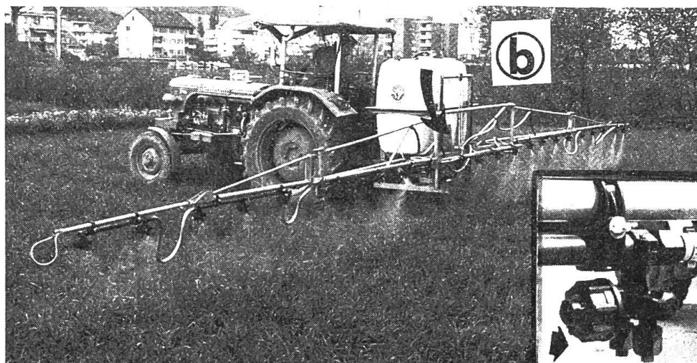
Abb. 1: Bei der Doppeltrapezaufhängung (a) passt sich das Spritzgestänge bis zirka 5% Hangneigung dem Gelände an. Eine Pendelaufhängung (b) dämpft die vertikalen und eine Arretierung der mittleren Gestängeteile die horizontalen Schwingungen. Eine Seilwinde (Pfeil) erleichtert die Anpassung der Düsenhöhe über den Zielflächen. Zwillingsdüsen mit Membran-Rückschlagventil (rechts) ermöglichen bezüglich Spritzqualität eine rationelle Spritztechnik.
