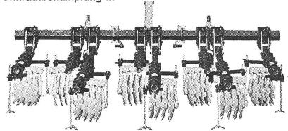
Bild: 4reihig (3 + 2) für Reihenabstände 70 - 75 - 80 cm
