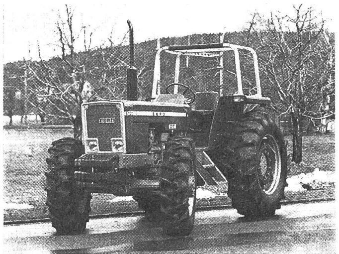
EBRO-Allradtraktor E-6100-DT (mit 6-Zylinder-Diesel PERKINS).
