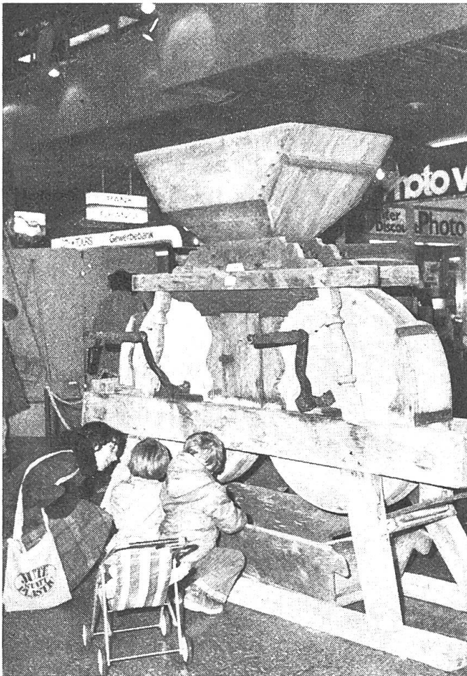
Abb. 3: Auch die Obstmühle, noch von Hand betrieben, ist damals eine «Erfindung» gewesen, weil erst sie die Mostbereitung richtig ermöglichte. Da das Pressen der Trauben einfacher war, wurde in früheren Zeiten jedes nur einigermaßen geeignete Grundstück mit Reben bepflanzt.
