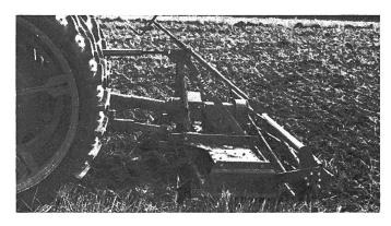
Abb. 18: Der Planierbalken aus einem Rohr hat nur eine ausebnende Wirkung (Trident).
