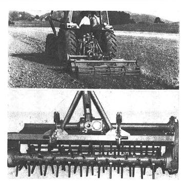
Abb. 10: Eine mit Zinkenrotor ausgerüstete Fräse kann zur Saatbettvorbereitung praktisch in allen Bodenarten (ohne Schmierschichtbildung) eingesetzt werden (Celli).
