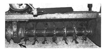
Abb. 11: Die Haltbarkeit der Sichelmesser gegenüber von Winkelmessern ist etwas geringer. Der Lockerer unter dem Getriebegehäuse (Pfeil) ist einem grösseren Verschleiss ausgesetzt.
