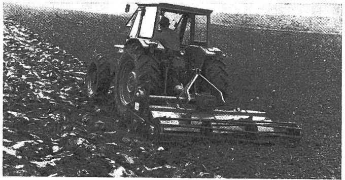
Abb. 7: Bei der Bearbeitung von feuchteren Böden ist eine grossdimensionierte offene Krümlerwalze vorteilhaft (Krone).
