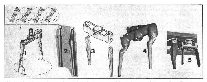
Abb. 14: Die Arbeitswerkzeuge der elf Kreiseleggen lassen sich nach Form und Querschnitt in fünf Gruppen einteilen: 1) Rundzinken I, H; 2) Ovalzinken J, K, E; 3) Stabzinken D, C, G; 4) gekröpfte, drehbare Zinken B; 5) Messer A, F, links — Anstellwinkel in der Drehrichtung.
