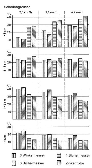
Abb. 5: Der Zerkleinerungseffekt wird bei gleicher Umfangsgeschwindigkeit hauptsächlich durch die Fahrgeschwindigkeit und die Messerzahl je Kranz (Bissenlänge) beeinflusst. (Saatbettvorbereitung nach einer Pflugfurche im Herbst, Schollenanalyse aus 0 bis 10 cm Tiefe, Lehmboden).
