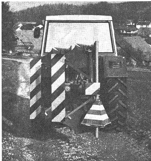
Abb. 3: Beim Pflug sind es vor allem die Riesternende, welche bei einem Zusammenstoss gefährlich werden könnten. Hier gilt es, sie auf einfache Art abzudecken, was mit wenig Geschick jeder Bauer selber machen kann. Der Signalkörper darf nicht mehr als 90 cm über Boden angehängt werden, sonst ist noch ein zusätzliches Licht erforderlich.
