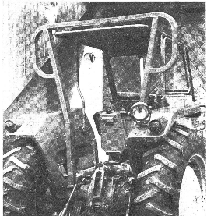
Abb. 7: Ein starrer Schutzbügel mit Wetterverdeck und abgerundetem Oberteil (n. Meyer).
