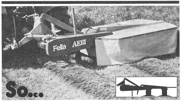
**Fella Kreiselmäher KM165 und KM190** Arbeitsbreiten 1,65 und 1,90 m. Antrieb über Keilriemen und Kegelradgetriebe im Fettbad. Auflaufsicherung und automatische Transportverriegelung. Messerwechsel mittels Schnellverschlüssen. Bodenanpassung nach oben 30° und nach unten 18°.
