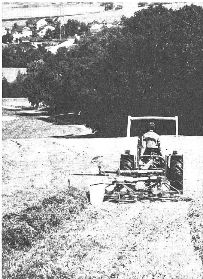
Abb. 4: PZ-Zweegers schwadet als einziges Fabrikat seitwärts.
