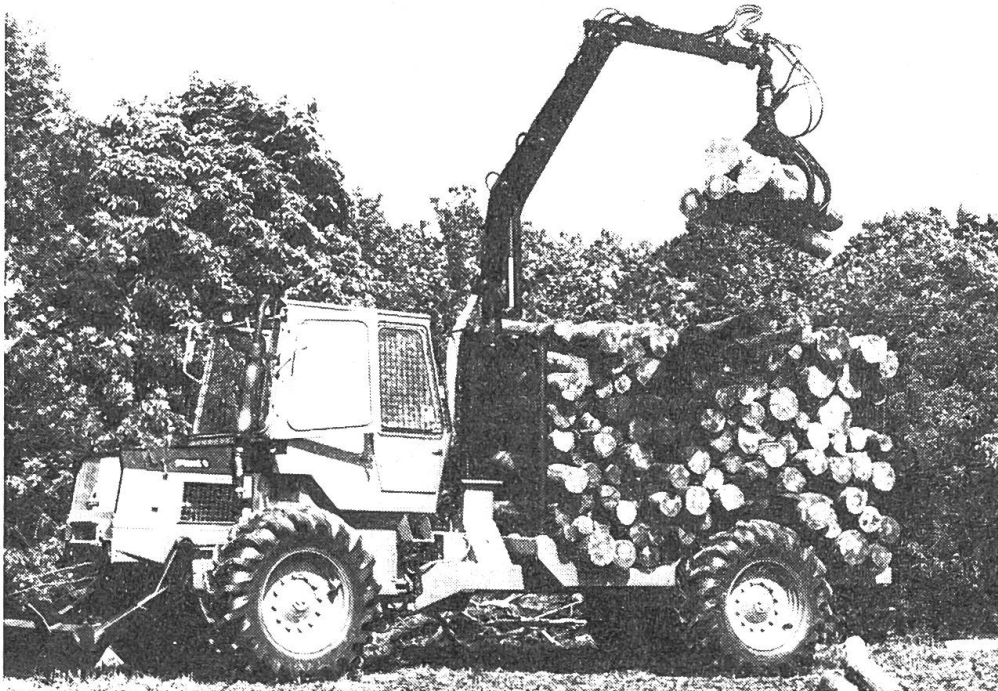
Abb. 1: Renault / Cemet – Forst- traktor SM 255 mit star- rem Fahrgestell und 4-Rad-Antrieb. Leistung: 65,5 kW (88 PS).
