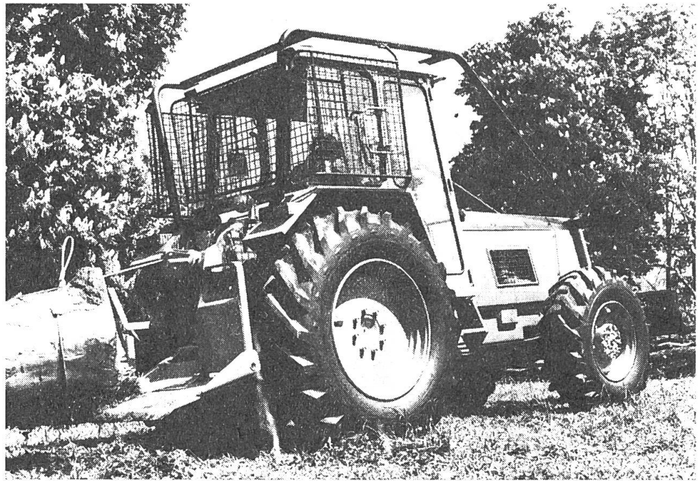
Abb. 1: Renault / Cemet – Forst- traktor SM 255 mit star- rem Fahrgestell und 4-Rad-Antrieb. Leistung: 65,5 kW (88 PS).
